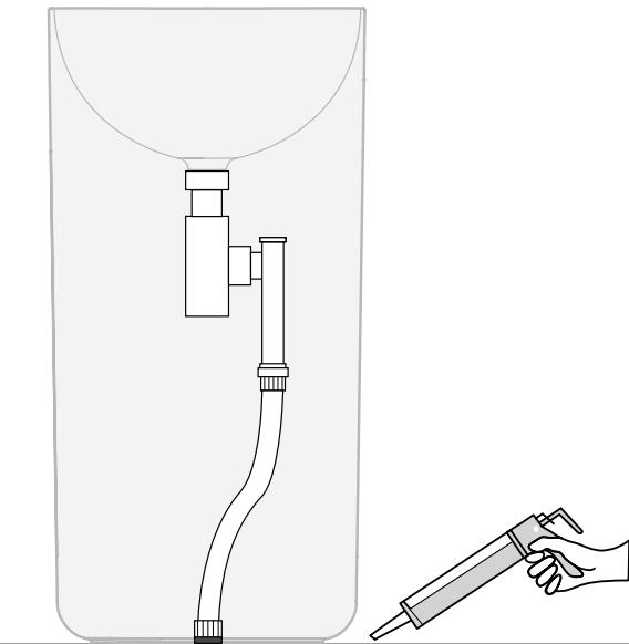
Raccorder le siphon d'évacuation au lavabo. Introduire la partie terminale du siphon dans l'évacuation au sol précédemment installée. Appliquer une légère couche de silicone sur le pourtour de la base du lavabo et le mettre dans la position désirée. Nous recommandons l'utilisation d'un silicone universel anti-moisissure.
