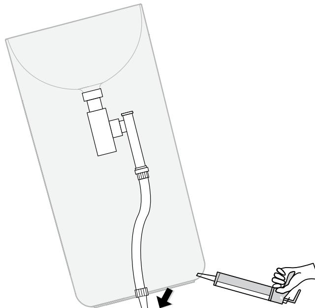
Una volta posizionato il lavabo nella posizione desiderata, applicare un leggero strato di silicone nel perimetro esterno del lavabo a contatto con il pavimento. Rimuovere la parte eccedente di silicone con l'aiuto di carta assorbente. Raccomandiamo di utilizzare un silicone universale anti muffa.
