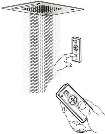
**Nota:** un telecomando può essere associato a più soffioni e pilotarli contemporaneamente. Non è invece possibile pilotare un singolo soffione con più telecomandi.
