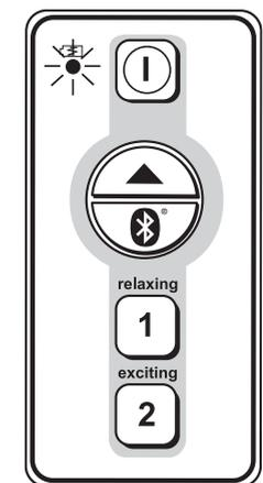
● Die Fernsteuerung wird durch 2 Alkalibatterien des Typs AAA zu 1,5 V gespeist. Wenn, beim Einschalten das Display, die Rote licht erscheint, müssen Sie die Batterien ersetzen.
