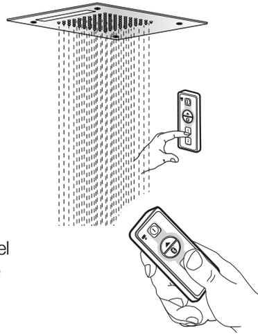
**Anmerkung:** eine Fernsteuerung kann mit verschiedenen Regenbrausen vereinigt werden und sie gleichzeitig steuern. Dagegen kann man keine einzelne Regenbrause mit verschiedenen Fernsteuerungen steuern.
