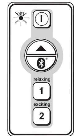
● Il telecomando è alimentato da 2 pile alcaline Tipo AAA da 1,5 V. All' accensione della luce rossa si consiglia la sostituzione delle pile.
